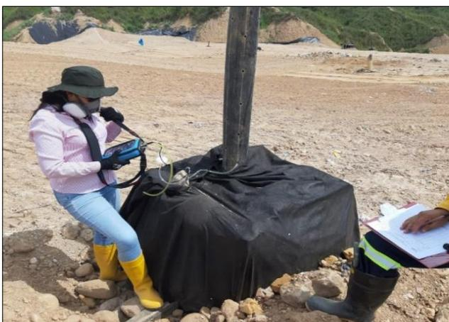
*Ilustración 18 Monitoreo de Gases In-Situ*
