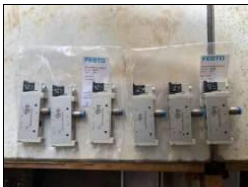
Ilustración 34 Reemplazo de electroválvulas
