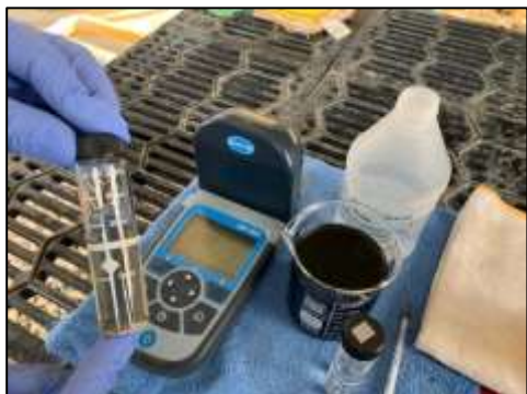
Ilustración 32 Medición de sólidos suspendidos totales (SST) en la entrada y salida DAF
