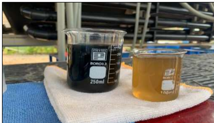
Ilustración 31 Apariencia lixiviado afluente DAF y clarificado del DAF
