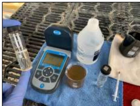
Ilustración 32 Medición de sólidos suspendidos totales (SST) en la entrada y salida DAF
