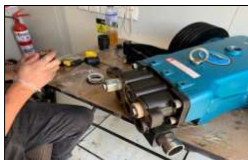
Ilustración 36 Bomba de alta presión tipo pistón
