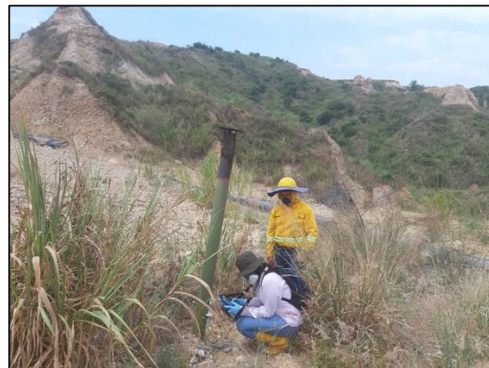
Ilustración 21 Caracterización de biogás celda de respaldo 1.
