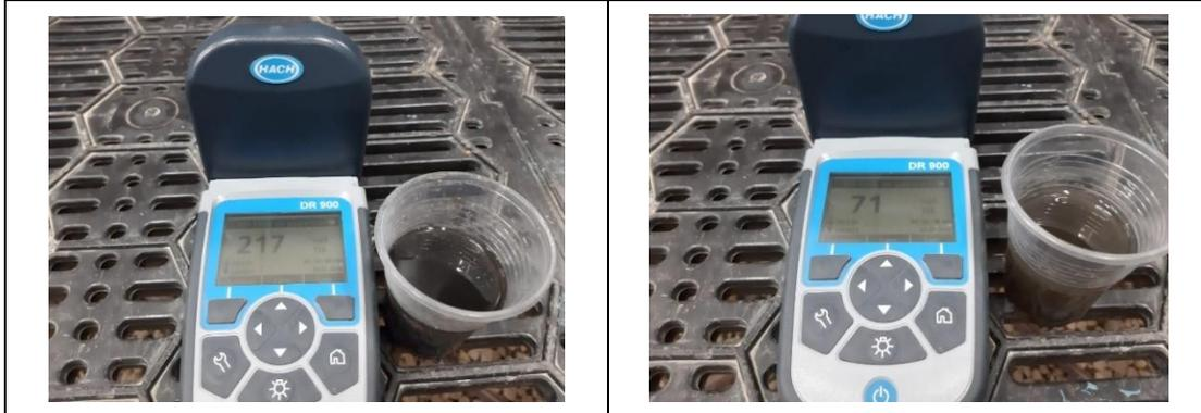
*Ilustración 25 Medición de sólidos suspendidos totales (SST) en la entrada y salida DAF Apariencia*
