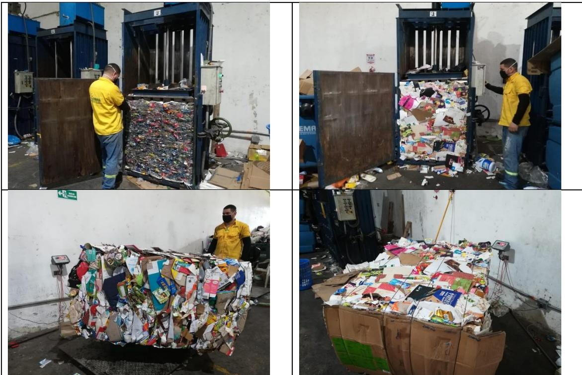
*Ilustración 31 Proceso de Compactación y pesaje*
