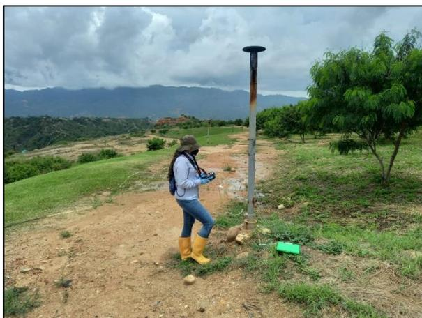
Ilustración 20 Caracterización de biogás celda 1 (domo)
