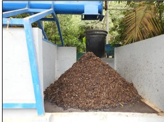
*Ilustración 11 Residuos orgánicos homogenizados en la celda de fermentación.*
