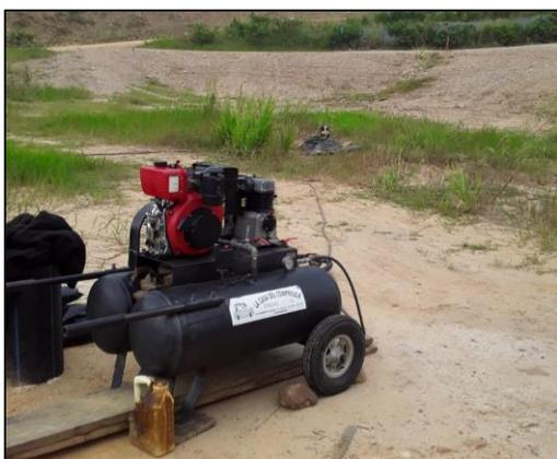
Ilustración 24 Extracción forzada de lixiviado pozo 6 celda de respaldo 1.
