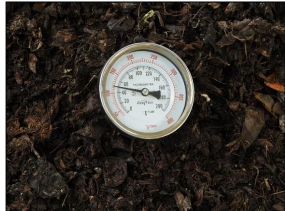
*Ilustración 13 Monitoreo de la temperatura en las pilas de la fase de descomposición.*
