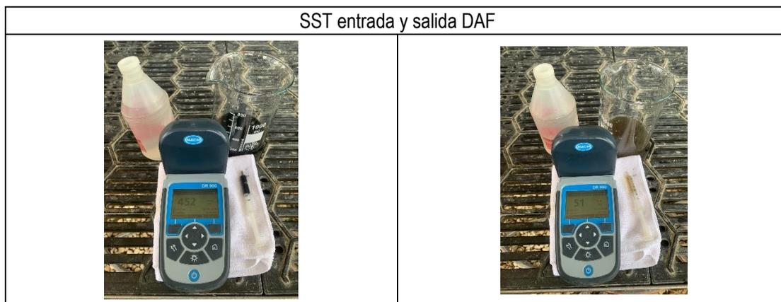
*Ilustración 26 Medición de sólidos suspendidos totales (SST) en la entrada y salida DAF.*
