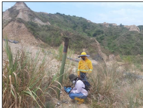
Ilustración 21 Caracterización de biogás celda de respaldo 1.
