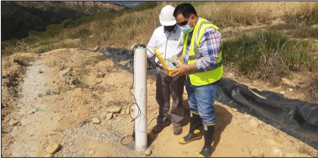
Ilustración 4 Medición de datos piezómetro PZ HV 1
