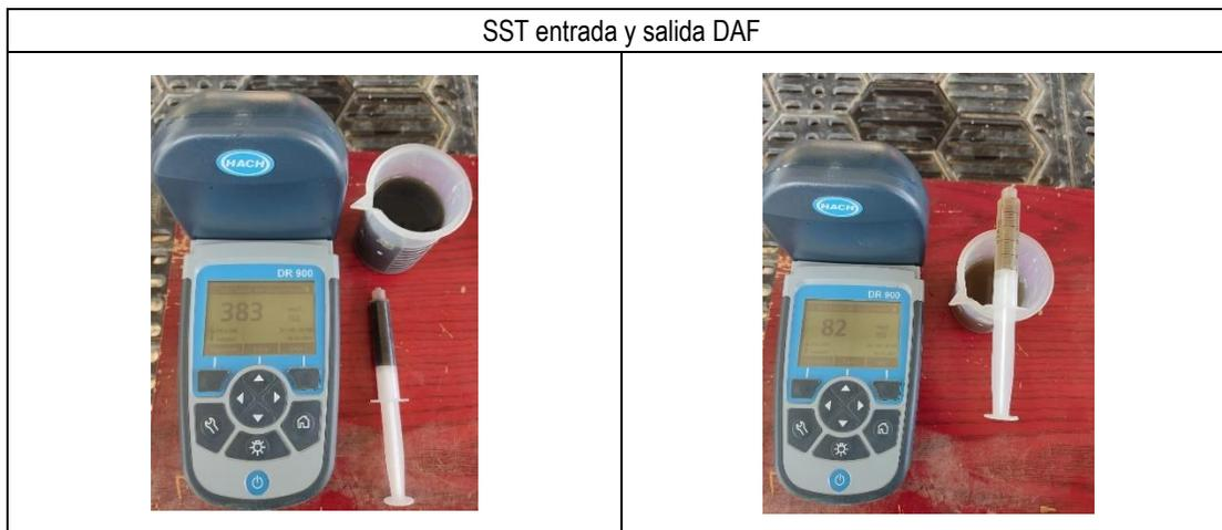
Ilustración 26 Medición de sólidos suspendidos totales (SST) en la entrada y salida DAF
