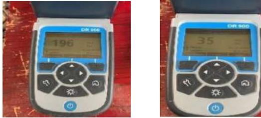
Medición de sólidos suspendidos totales (SST) en la entrada del DAF
