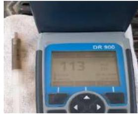
Medición de sólidos suspendidos totales (SST) en la entrada y salida DAF
