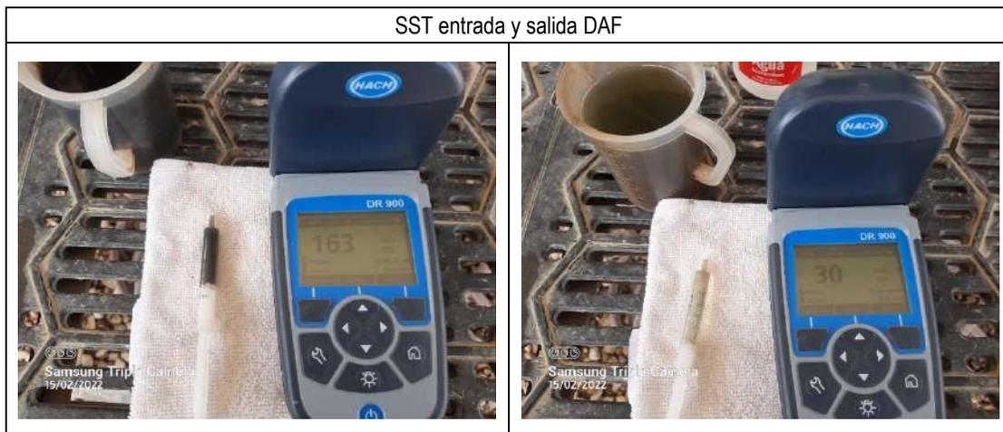
Ilustración 53 Medición de sólidos suspendidos totales (SST) en la entrada y salida DAF
