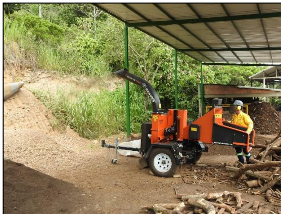
Ilustración 46 Chipeado de la fracción vegetal del material de podas y rocería
