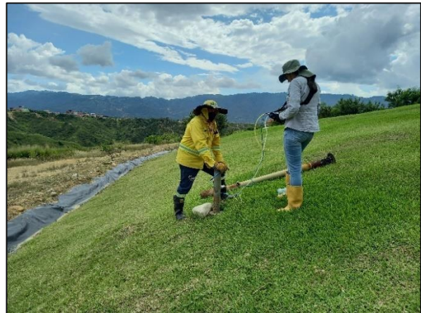
Ilustración 30 Caracterización de biogás celda 1 parte alta (domo).
