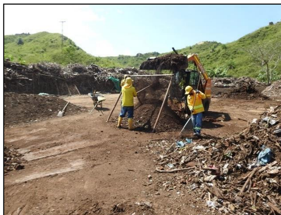
Ilustración 44 Limpieza y eliminación de inorgánicos y troncos del material vegetal en proceso de compostaje
