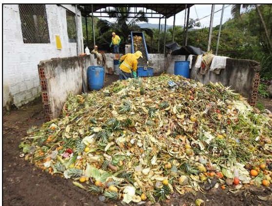
Ilustración 43 Material orgánico de plazas en proceso de homogenización
