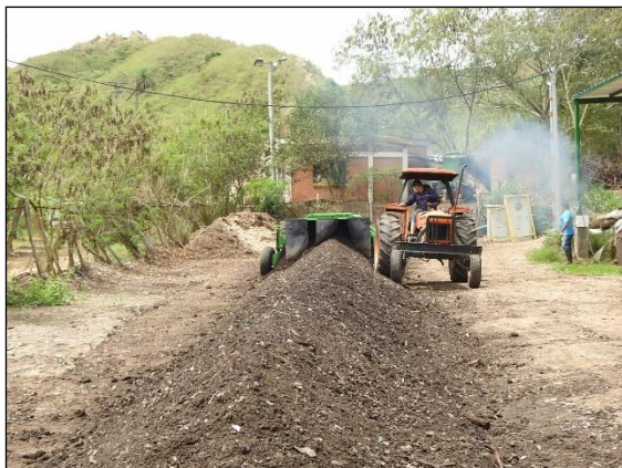
Ilustración 45 Volteo mecanizado de pilas en descomposición
