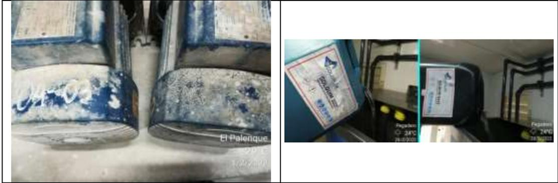
**Registro Fotográfico No. 7.** Mantenimiento de la bomba de lodos y Mantenimiento a la bomba BR1 (Cambio de rodamientos)
