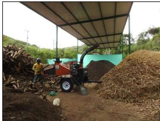
*Ilustración 44 Chipeado de la fracción vegetal del material de podas y rocería*
