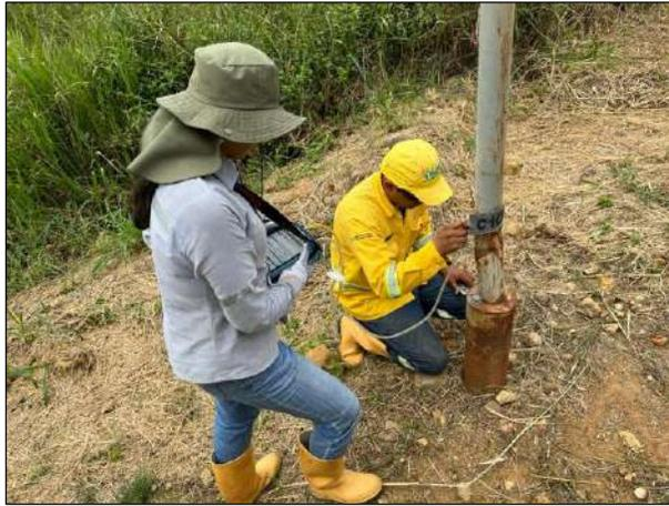
*Ilustración 29 Caracterización de biogás celda 1.*
