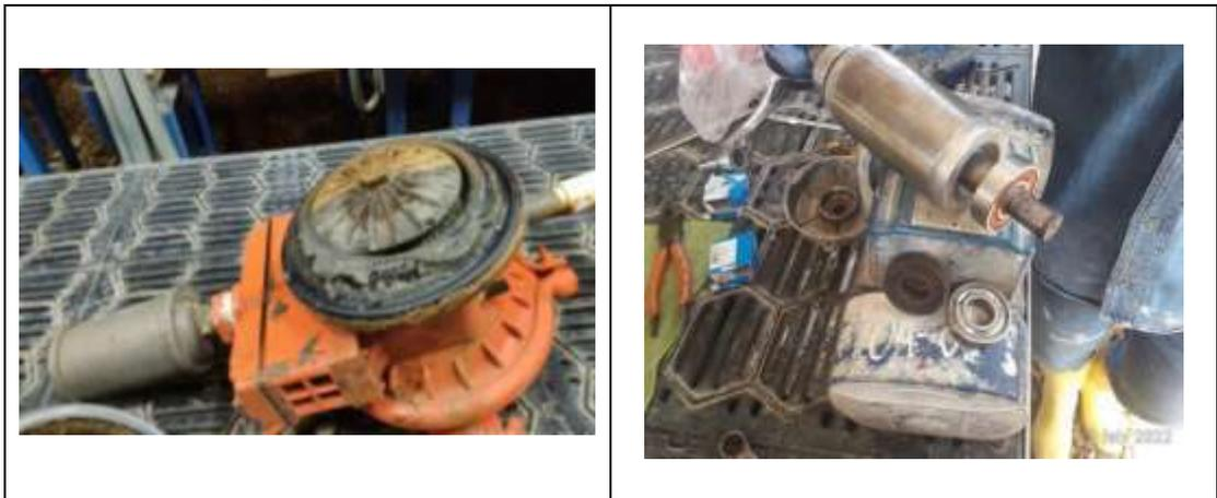
**Registro Fotográfico No. 8.** Mantenimiento preventivo de la bomba de recirculacion DAF y Limpieza tubería de succión de la bomba del pozo
