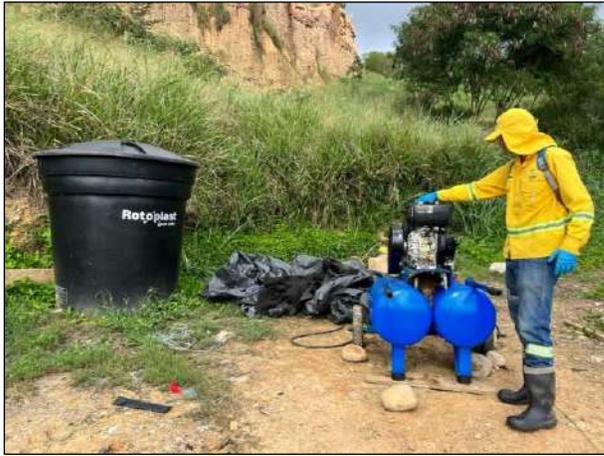
Ilustración 34 . Extracción forzada celda 3 PEF 2 y PEF16.
