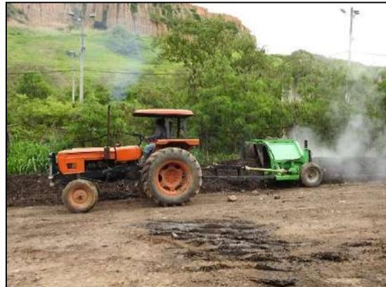
*Ilustración 42 Volteo de pilas en descomposición para aireación*
