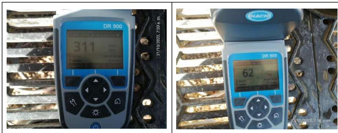
*Ilustración 37 Medición de sólidos suspendidos totales (SST) en la entrada y salida DAF*
