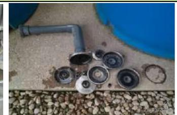
Inspección y limpieza de la bomba de recirculación del DAF
