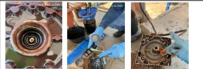
Mantenimiento bomba hidráulica del filtro prensa
