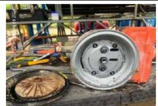
Mantenimiento preventivo bomba neumática de lodos
