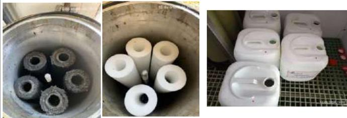
Mantenimiento de la unidad de microfiltración y las membranas propias del equipo
