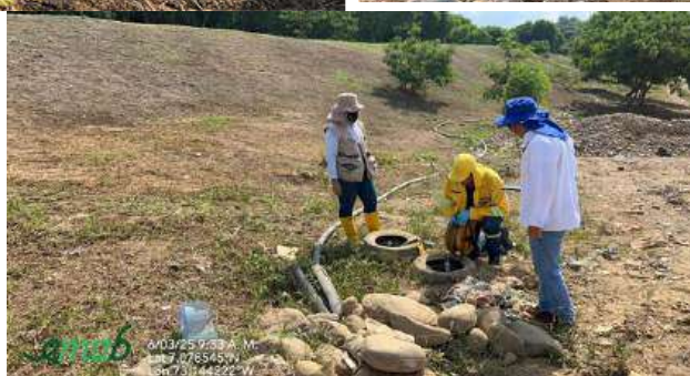
Ilustración 13 Lectura de Piezómetros de sonda geoelectrica, 2025
