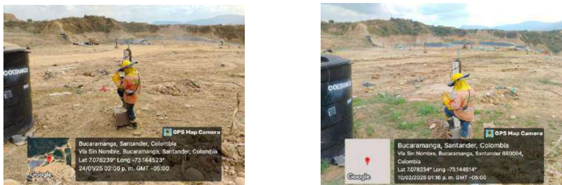
Ilustración 12 Lectura de Piezómetros de hilo vibrátil, 2025
