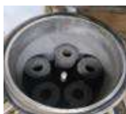
Mantenimiento de la unidad de microfiltración y las membranas propias del equipo
