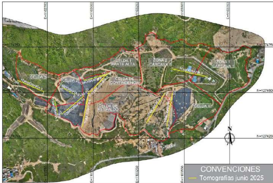
Figura Localización de las líneas de tomografía geoelectrica de la I Campaña de 2025.
