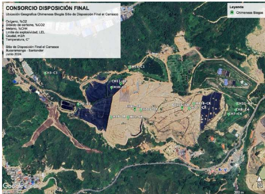
Figura Ubicación Geográfica de las fuentes fijas del relleno sanitario – monitoreo de la composición del biogás y límite de explosividad LEL
