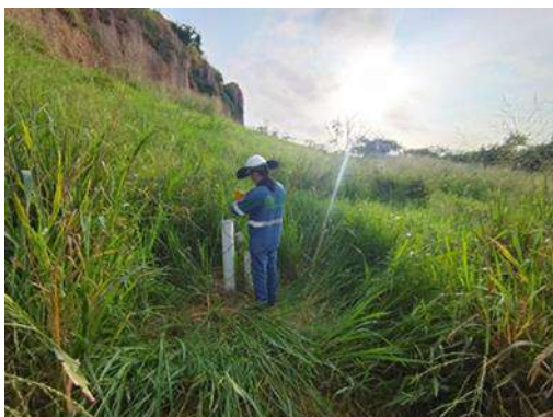
Ilustración Lectura de Piezómetros de hilo vibrátil, periodo de enero a diciembre de 2025
