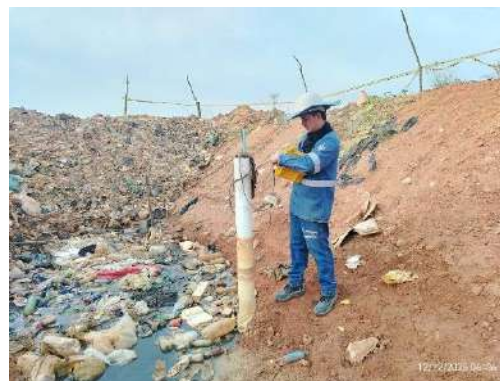
Ilustración Lectura de Piezómetros de hilo vibrátil, periodo de enero a diciembre de 2025
