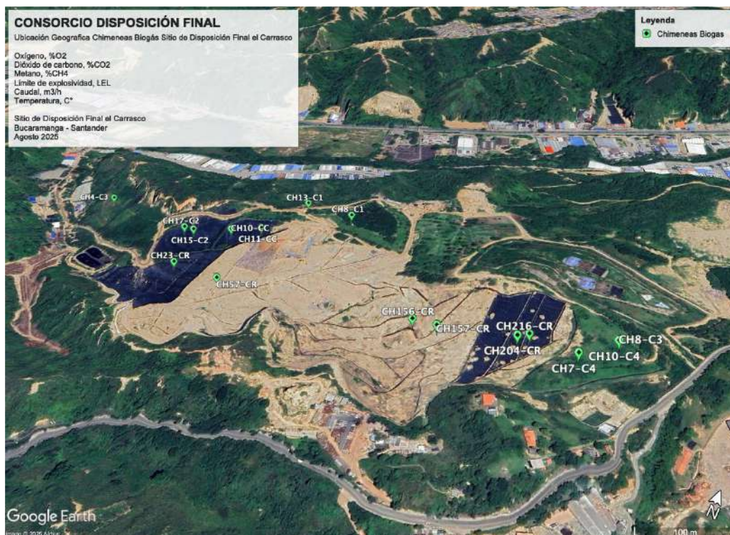
Figura Ubicación Geográfica de las fuentes fijas del relleno sanitario – monitoreo de la composición del biogás y límite de explosividad LEL, agosto de 2025
