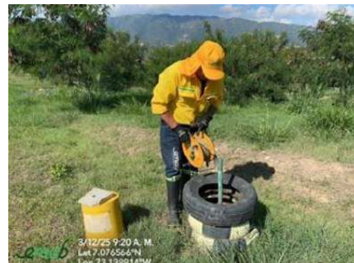
Ilustración Lectura de Piezómetros de sonda geoelectrica, enero a diciembre de 2025
