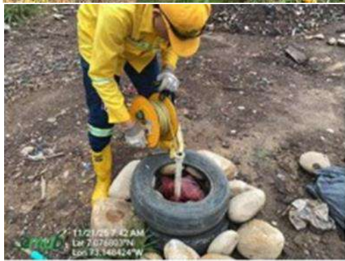
Ilustración Lectura de Piezómetros de sonda geoelectrica, enero a diciembre de 2025
