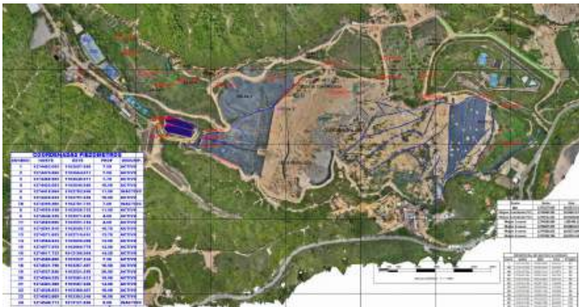
Figura 10 Localización espacial de los 23 sondeos de nivel freático instalados en El Carrasco.
