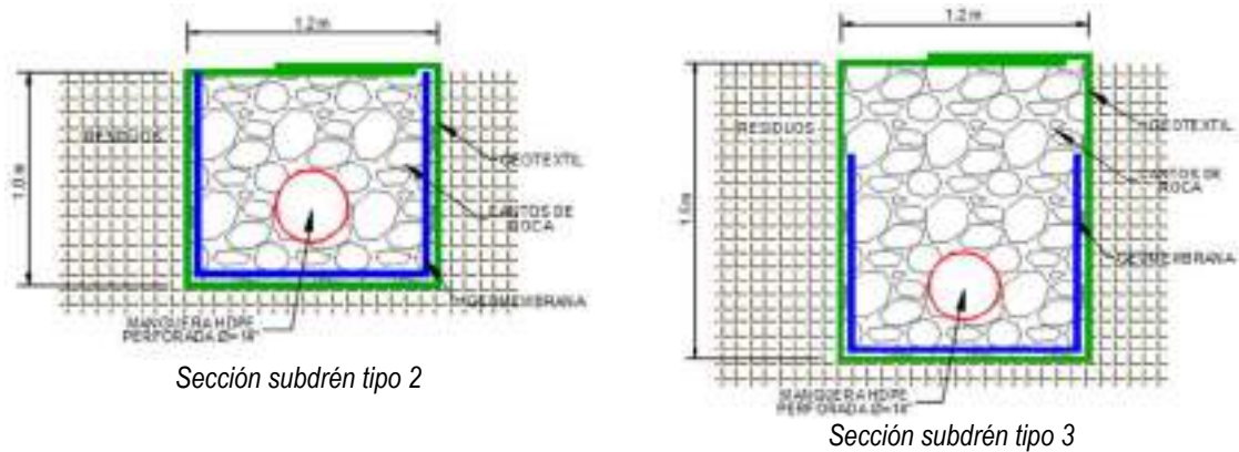
Figura 6 Sección subdrén tipo 2 y 3
